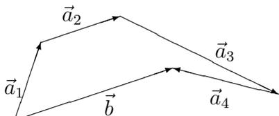
$$\vec{b} = \vec{a}_1 + \vec{a}_2 + \vec{a}_3 + \vec{a}_4 \text{ (Рис.1.9)}$$
