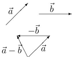
1) Из определения разности векторов вытекает правило для построения разности векторов  $\vec{a}$  и  $\vec{b}$  (Рис.1.10): чтобы из вектора  $\vec{a}$  вычесть вектор  $\vec{b}$ , нужно к вектору  $\vec{a}$  прибавить вектор, противоположный вектору  $\vec{b}$  (например, по правилу треугольника).
